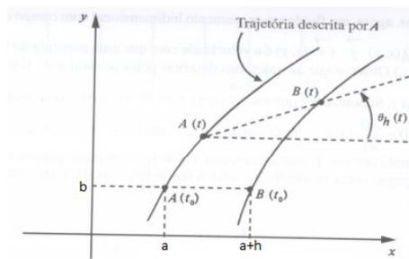
Figura 3.14: Ilustração usada na interpretação física do rotacional.
